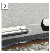
Auf der Rückseite des Grundprofils 90527 zwei parallel verlaufende geradlinige Kleberraupen auftragen (jeweils ca. 5 mm breit, Auftragsmenge in Abhängigkeit von der Untergrundbeschaffenheit).
