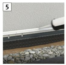
Fuge zwischen Alu-Grundprofil 90527 und Untergrund kann mit geeignetem Dichtstoff in weiß oder anthrazit (z.B. Tremco–Illbruck SP 525) ausgefugt werden. Dazu Klebdichtstoff in Fugenbreite auflegen und innerhalb der Hautbildezeit glätten.
