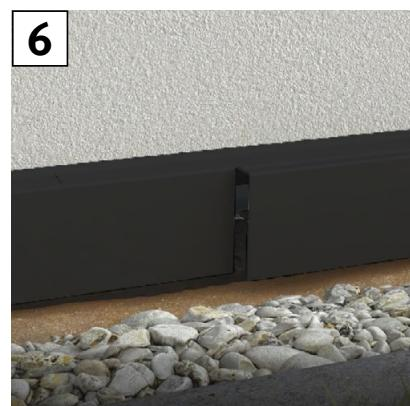
Danach PVC-Abdeckprofil 37527 im gewünschten Farbton aufklippen. Kabel oder Mikroschlauch kann eingelegt werden. Stoßüberlappung der PVC-Abdeckprofile mit dem Aluminium-Grundprofil sicherstellen. Am Stoß der Einzelstäbe einem Abstand von 1 - 2 mm belassen.
