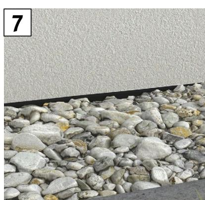
Danach Anschüttung der Kiesdrainage bis zur Profiloberkante.
