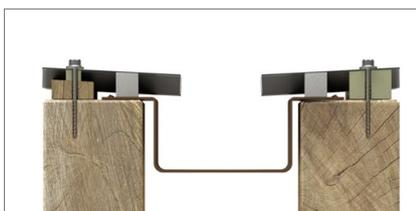
Der Versatz/Abstandshalter sorgt dafür, dass durch die Eindeckung keine Klemmwirkung entsteht und die Carportrinne sich unabhängig von der Dachkonstruktion thermisch bewegen kann. Das Gefälle der Carportrinne darf zwischen 0-3 mm/m liegen.
