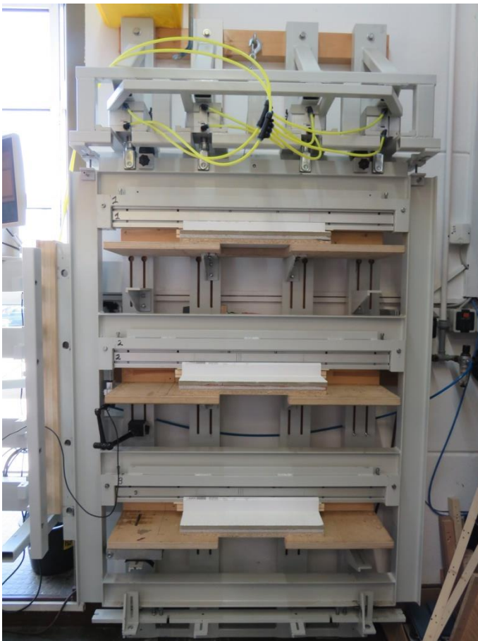
Bild 2 Prüfaufbau für Scherung quer
