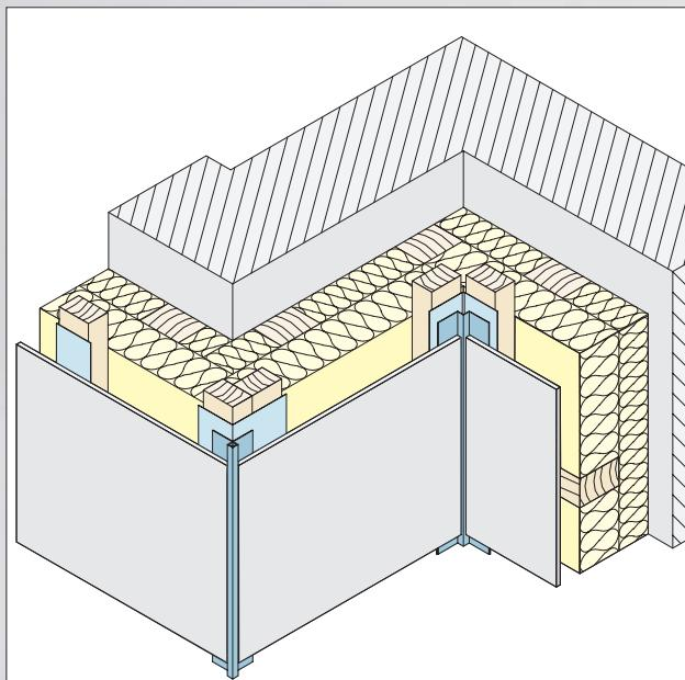
Kantenprofile dienen der Fassadengestaltung. Sie bedecken die Schnittkanten der Fassadentafeln und bilden eine saubere Kante.
