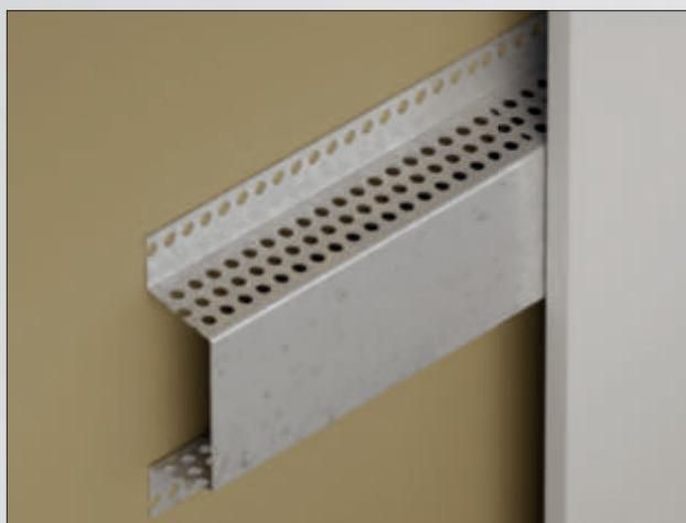
Das PROTEKTOR Omega-Lüftungsprofil (Art.-Nr. 9363) ist ein Hutprofil aus Aluminium mit Lüftungslöchern. Die Höhe des Profils beträgt 30 mm; der Boden ist 60 mm breit. Entlang des Profils sind Lüftungslöcher mit einem Durchmesser von 5 mm angebracht. Der freie Lüftungsquerschnitt am Schenkel 30 mm beträgt  $75 \text{ cm}^2/\text{lfm}$ . Die Materialdicke beträgt 1 mm. Das Protektor Omega-Lüftungsprofil ist vielseitig verwendbar.
