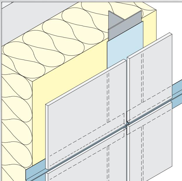
Das Fugen- bzw. Sickenprofil aus Aluminium schließt und hinterlegt dezent die Fuge. Die Sicke am Profil bewirkt auch eine Zentrierung und Führung in der Fuge der Fassadenbekleidung. Die Profile gibt es daher in 6 mm und 9 mm Breite für verschiedene Fugenbreiten. Das Sickenprofil kann horizontal und vertikal eingesetzt werden.
