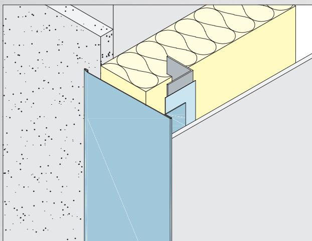
Die Anschlussprofile schließen die Fassadenbekleidung an anderen Flächen der Fassade wie z. B. Putz an und ermöglichen einen einfachen und sauberer Übergang. Sie bedecken die Schnittkanten der Fassadentafeln, bilden einen sauberen Anschluss und decken seitlich die Unterkonstruktion ab.
