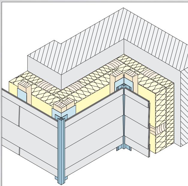
Kantenprofile dienen der Fassadengestaltung. Sie überdecken und schützen die Schnittkanten der Fassadentafeln vollständig und bilden dadurch eine saubere Kante.
