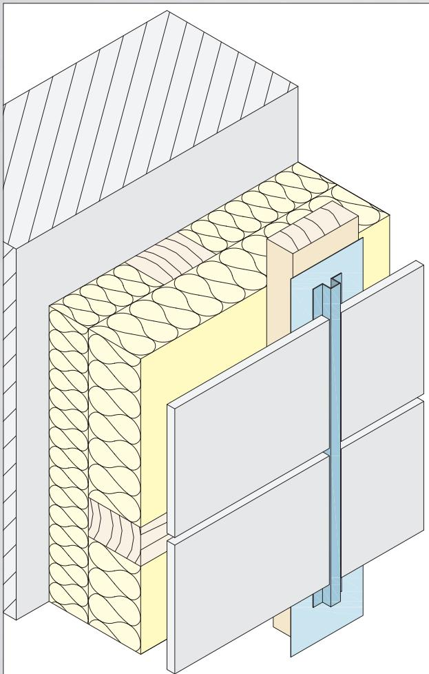
Die Fugenprofile aus Aluminium bzw. PVC finden Ihre Anwendung bei vertikaler Fuge. Je nach Anwendung ist darauf zu achten, dass eine Ausdehnung der Fassadenbekleidung möglich ist. Die Fugen- bzw. Hutprofile aus Aluminium können rückseitig oder vorderseitig der Fassadenbekleidung montiert werden.
