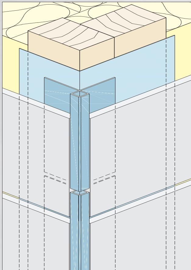
Die vertikalen Profilstöße der Aluminium-Kantenprofile können auch versetzt zur Fuge der Fassadenbekleidung angeordnet werden. Der grundsätzliche Einsatz von Fugenbändern kann das Eindringen von Wasser verhindern.
