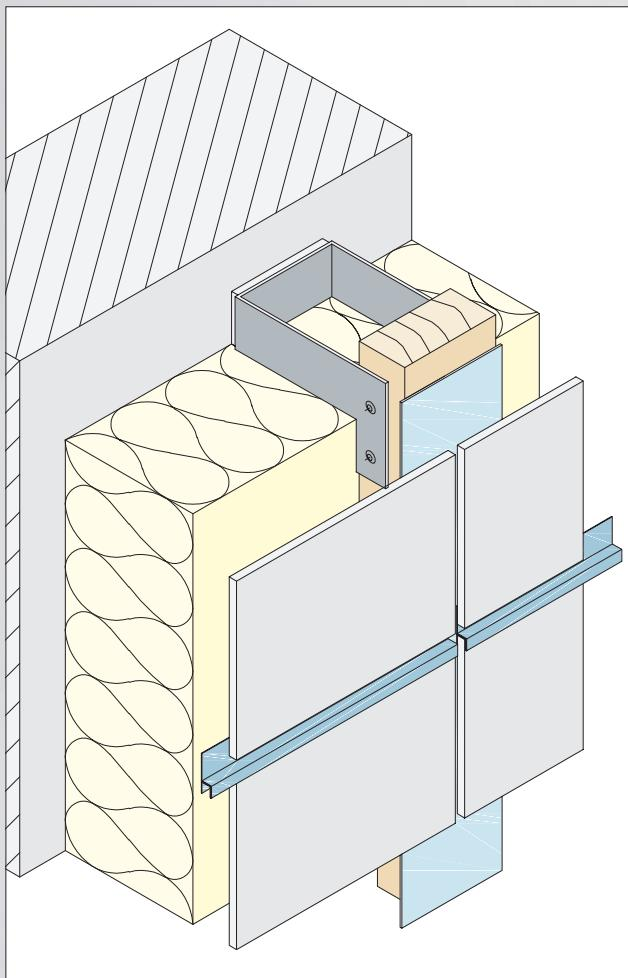
Die Fugenprofile bzw. h-Profil aus Aluminium und PVC finden Ihre Anwendung bei der horizontalen Fuge. Sie reduzieren das Eindringen von Feuchtigkeit. Bitte achten Sie darauf, dass die Platten nicht auf das Profil direkt aufgesetzt werden, sondern eine Fuge von ca. 5 bis 10 mm bzw. nach Angabe des Plattenherstellers gelassen wird.
