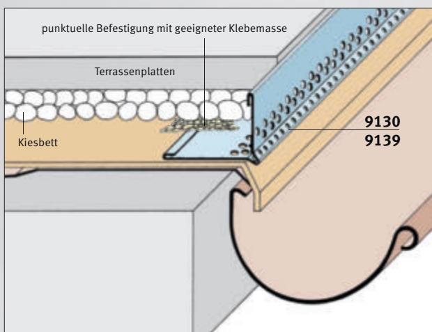
Die Kiesfangleiste ist für lose verlegte großflächige Balkon- und Terrassenplatten geeignet. Die Kiesfangleiste ist mit geeigneter Klebemasse punktuell zu fixieren. Als Untergrund für die Terrassenplatten muss ein geeigneter tragfähiger Untergrund und Aufbau angebracht werden. Geeigneter Kies/Splitt ist fachgemäß zu verdichten. Die Kiesfangleiste darf durch Lasten und Bewegungen der Terrassenplatten nicht beansprucht werden.
