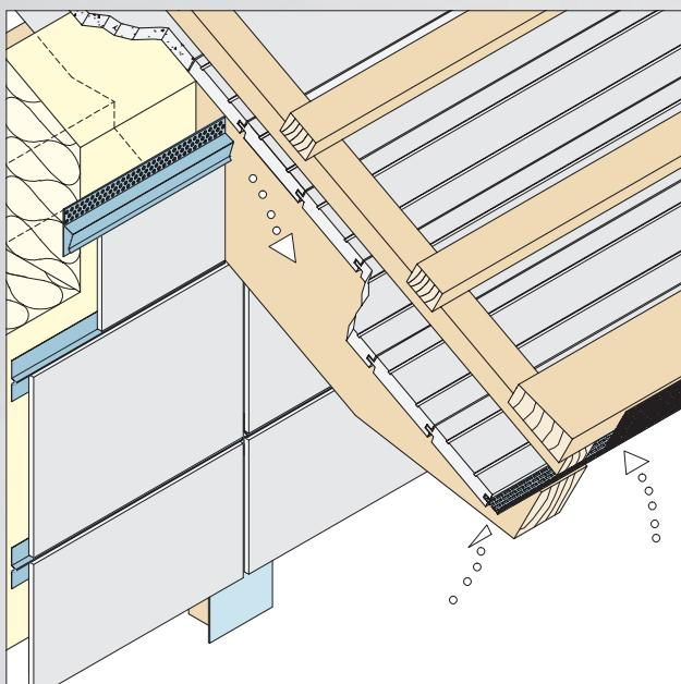
Die Lüftungsprofile 9056 und 9059 werden im oberen Fassadenbereich sowie unter den Fensterbänken eingesetzt. Die Profile können für Plattendicken von 4–6 mm und 8–15 mm verwendet werden.
