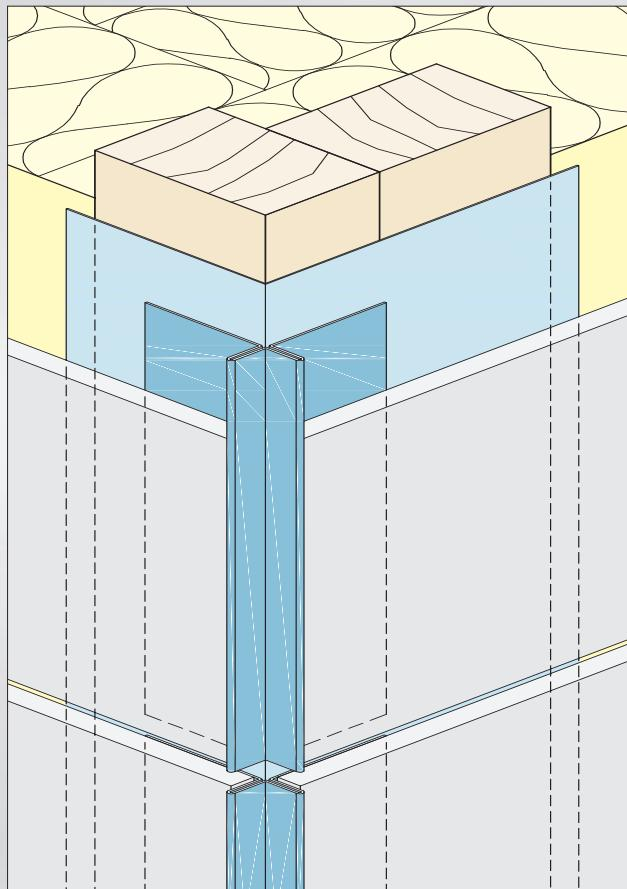
Beim Einsatz von Aluminium-Kantenprofilen können die vertikalen Profilstöße mit einer Fuge der Fassadenbekleidung übereinstimmen. Der grundsätzliche Einsatz von Fugenbändern kann das Eindringen von Wasser verhindern.
