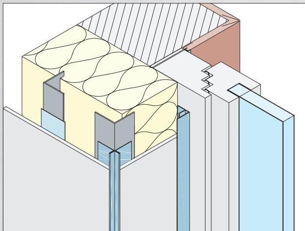
Die Laibungsausbildung kann auf unterschiedliche Arten ausgeführt werden. In der Praxis wird je nach Wunsch des Bauherrn u. a. die Fassadenbekleidung in der Laibung fortgesetzt oder auf bestehende Systeme zurückgegriffen.
