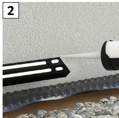
Auf der Rückseite des Grundprofils 90527 zwei parallel verlaufende geradlinige Kleberrauen auftragen (jeweils ca. 5 mm breit, Auftragsmenge in Abhängigkeit von der Untergrundbeschaffenheit).
