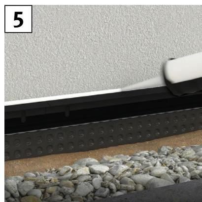
Fuge zwischen Alu-Grundprofil 90527 und Untergrund kann mit geeignetem Dichtstoff in weiß oder anthrazit (z.B. Tremco-Illbruck SP 525) ausgefügt werden. Dazu Klebdichtstoff in Fugenbreite auflegen und innerhalb der Hautbildezeit glätten.
